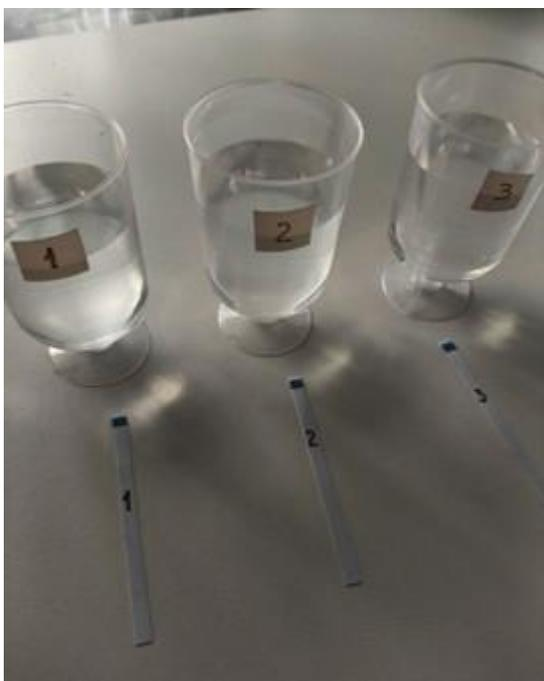
Вертикально погрузил сенсорные элементы тест-полосок полностью в воду на 2-3 секунды (фото 4). Ровно через 1 минуту сравнил окраску каждого сенсорного элемента тест-полоски с соответствующим полем цветовой шкалы
